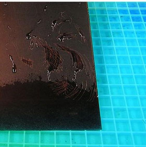
El fotograbado es el proceso de preparar imágenes o texto para impresión. Las imágenes se transfieren utilizando una combinación de métodos de fotografía y grabado con ácido. El resultado son placas con imágenes en bajorrelieve que después son pintadas con los colores precisos requeridos y lijadas, dejando el color sólo en las áreas en bajorrelieve.
