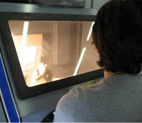
El método de sandblast utiliza aire comprimido que impulsa con fuerza un material abrasivo a través de una boquilla creando el grabado en el material.
